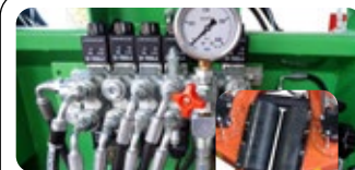
Kit de régulation de la pression de serrage du vibreur RD 75 et RD 90
