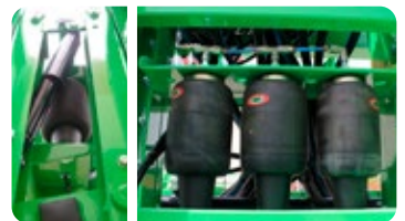
Suspension pneumatique renforcée S3 ou S4, selon rampe.
