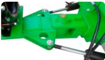
Timon directionnel articulé 2 verins hydrauliques manuelles.
